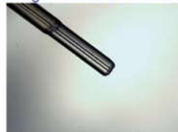
Aiguille de spotter en quartz patentée
